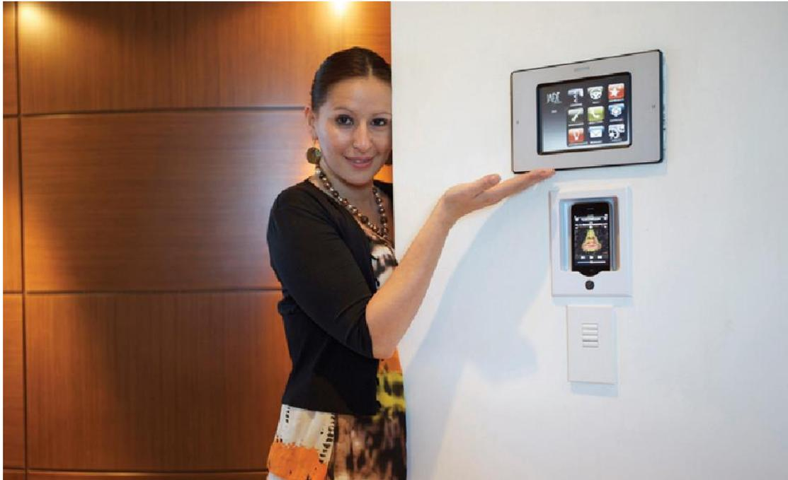
为了达成“翡翠海滩”对于外观和感觉的追求, Ikatu 选择了 RTI 的 K4 触摸屏。K4 为独立触摸面板，带有红外控制、视频监控和以太网连接，在标准配置中，K4 提供了 TFT LCD、全 VGA 分辨率、强大的 400-mhz 32 位 MCU、32MB 闪存、立体声扬声器和红外接收器。Ikatu 发现，K4 是唯一一个可满足所有需求的面板设备，而出现了故障时，它也能够重新启动，且不会与浏览器界面或任何其他不必要的元素进行交互。
